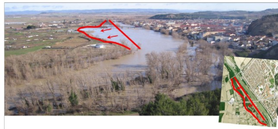
Figura 4. Devolución de espacio al río Aragón mediante retranqueo de un dique (Caparrosa).
