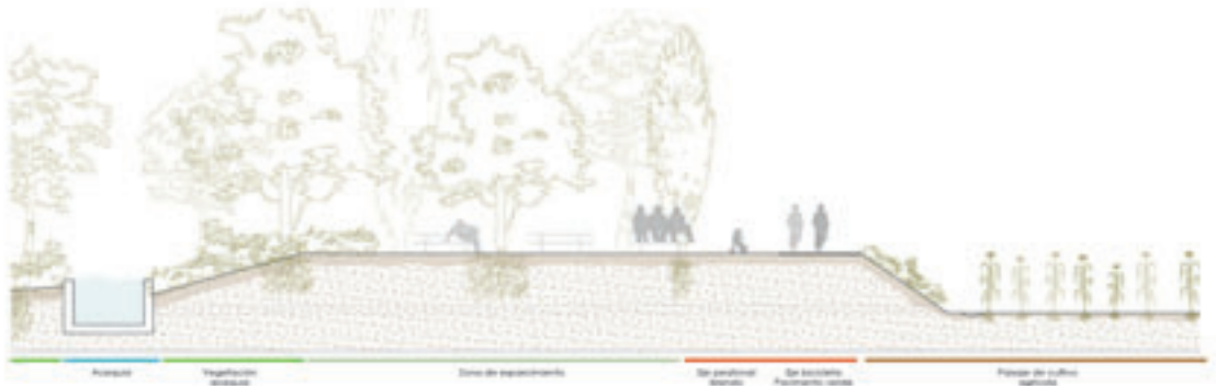
Sección tipo del camino peatonal y ciclista con zona de esparcimiento
