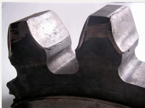
Desgaste en dientes de engranaje por lubricación inadecuada.
