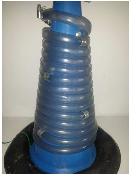
Figura 103: Nueva disposición de la tubería en espiral. Fuente propia
