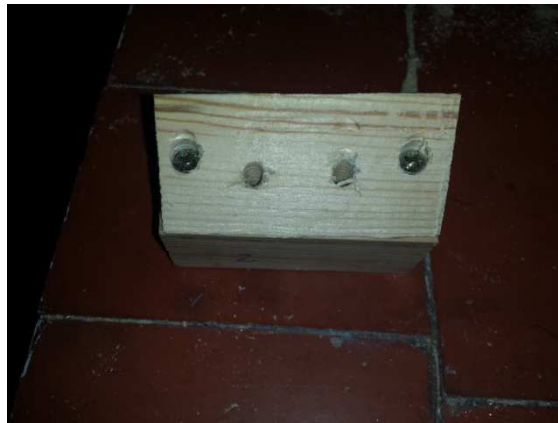
Figura 115. Unión de los tacos con las cuñas. Fuente propia
