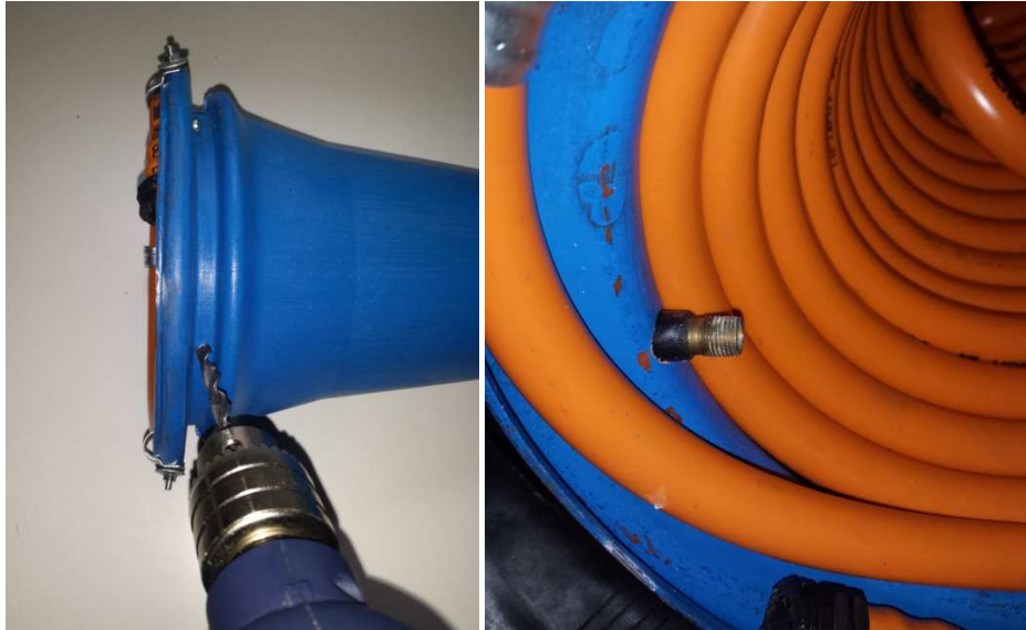
Figura 97: Colocación de la cámara de aire. Fuente propia
