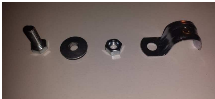
Figura 53: Elementos de fijación de la tubería en espiral. Fuente propia
