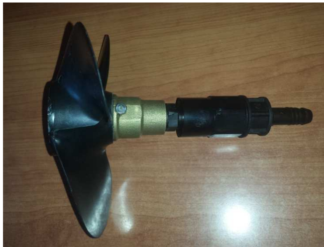
Figura 94: Junta rotatoria totalmente montada. Fuente propia
