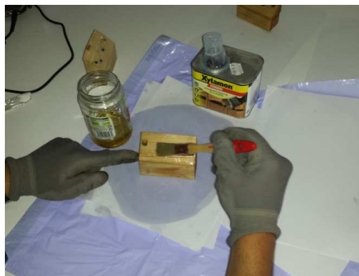
Figura 116: Barnizado protector de las cuñas. Fuente propia
