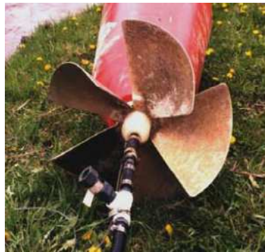
Figura 20: Vista de la válvula reguladora de presión en una Sling Pump. Fuente: Brown, (2006)
