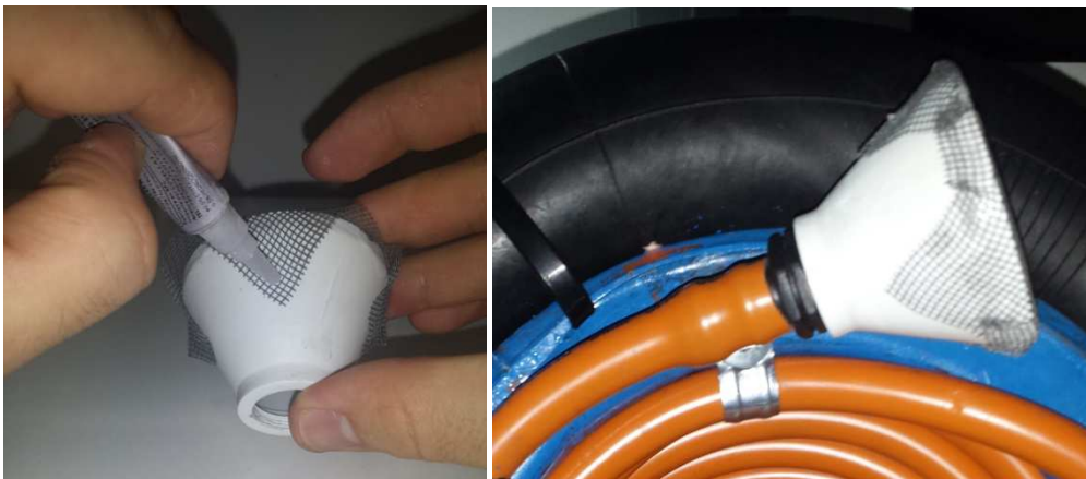
Figura 96: Colocación de la malla en el cono de admisión. Fuente propia
