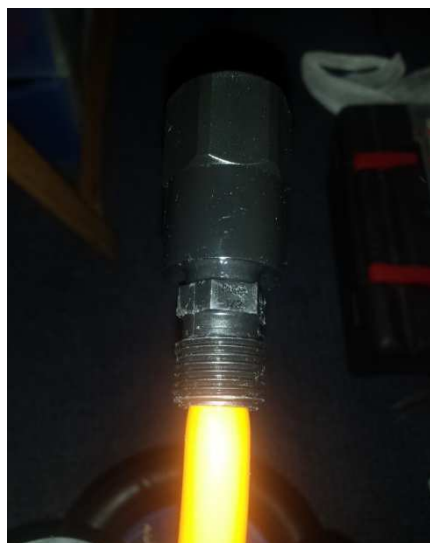
Figura 106: Unión de la tubería en espiral con el giro loco. Fuente propia
