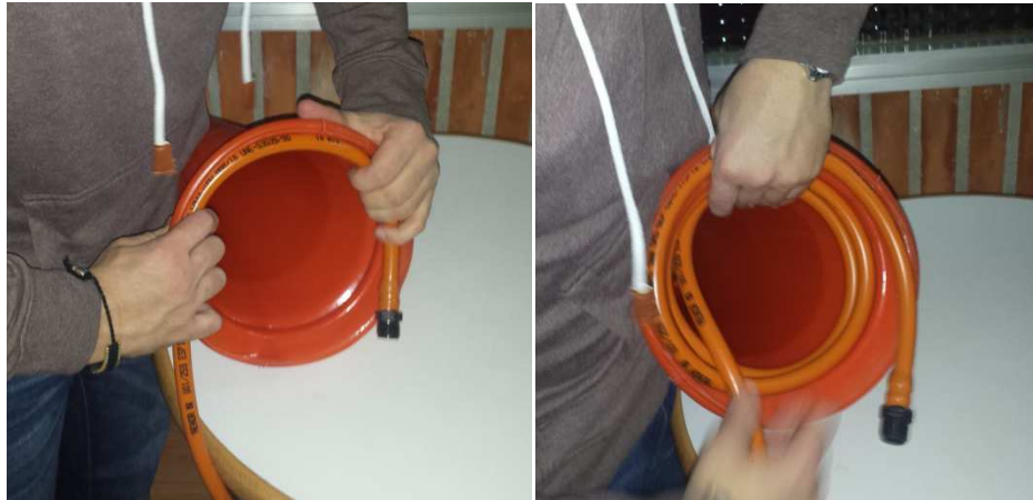
Figura 89: Enrollado de la tubería en espiral. Fuente propia
