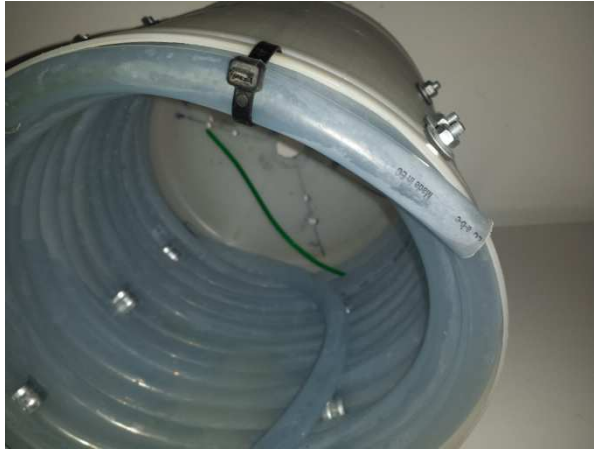
Figura 52: Tubería en espiral del prototipo 2. Fuente propia
