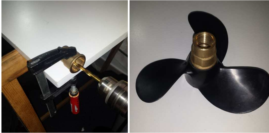
Figura 92: Adaptación del manguito al tamaño de la hélice. Fuente propia
