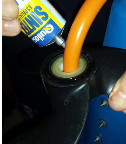
Figura 95: Pegado de la hélice al tambor. Fuente propia
