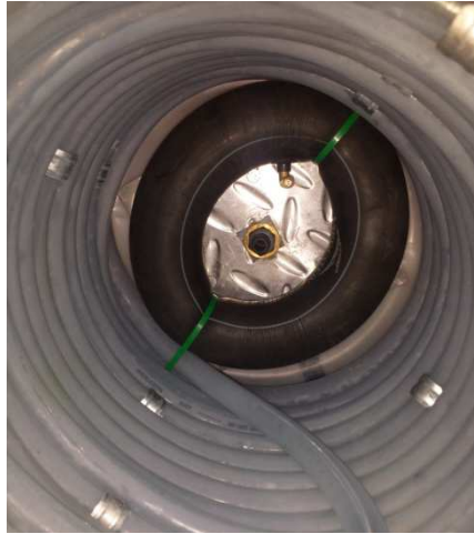
Figura 123: Fijación de la cámara de 10 ". Fuente propia
