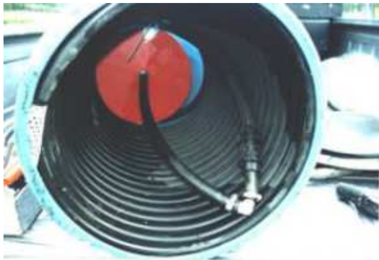
Figura 27: Vista interior del tambor de la Sling-pump Fuente: Brown, (2006)
