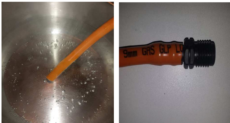
Figura 88: Unión de la tubería en espiral con una unión mixta. Fuente propia
