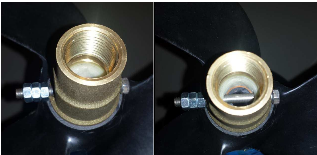
Figura 93: Detalle de la unión del manguito a la hélice. Fuente propia
