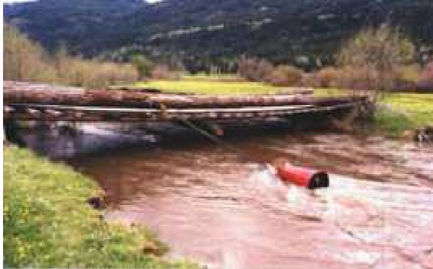
Figura 23: Imagen de una sling-pump sujeta por un cabo a un puente. Fuente: Brown, (2006)
