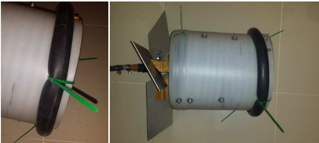
Figura 124: Fijación de la cámara de 12 ". Fuente propia
