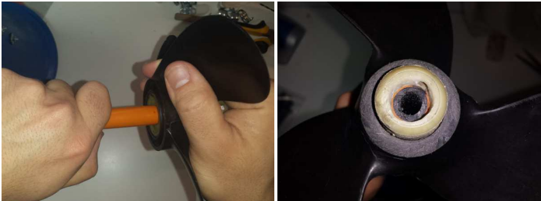
Figura 91: Detalle del paso de la tubería en espiral a través del núcleo de la hélice. Fuente propia
