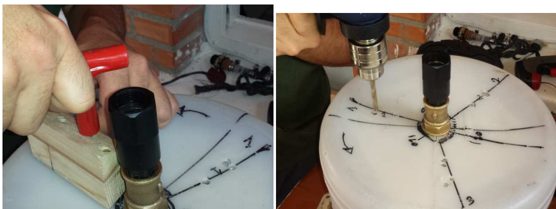
Figura 118: Unión de las cuñas al tambor. Fuente propia
