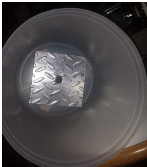
Figura 111: Colocación de la chapa metálica de 15x15 cm. Fuente propia
