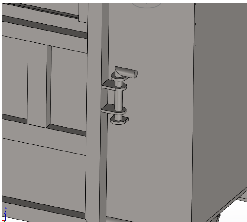
Figura 17: Cerradura compuerta inferior
