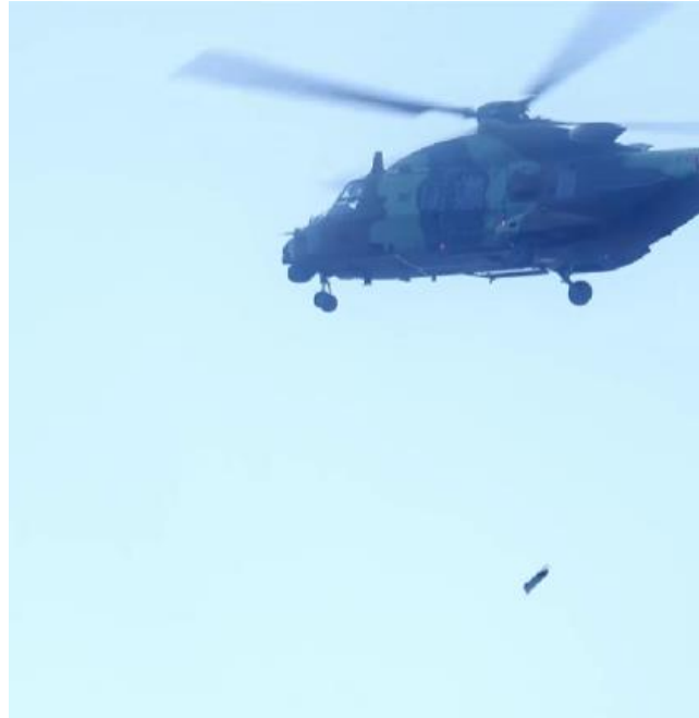
Figura 10 Momento en el que la tripulación del NH90 liberan el dron LE por una apertura en la parte inferior del helicóptero. Captura realizada del video publicado por Airbus en su cuenta oficial de Instagram: airbus_helicopters.
