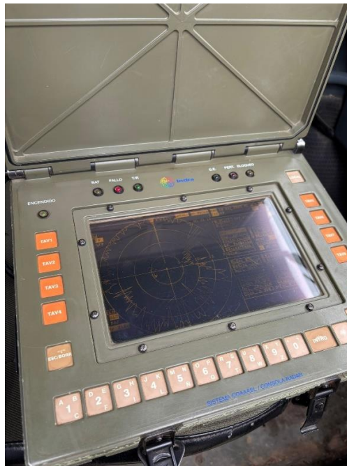
Figura 14: Pantalla terminal inteligente radar RAVEN (Fuente: elaboración propia)
