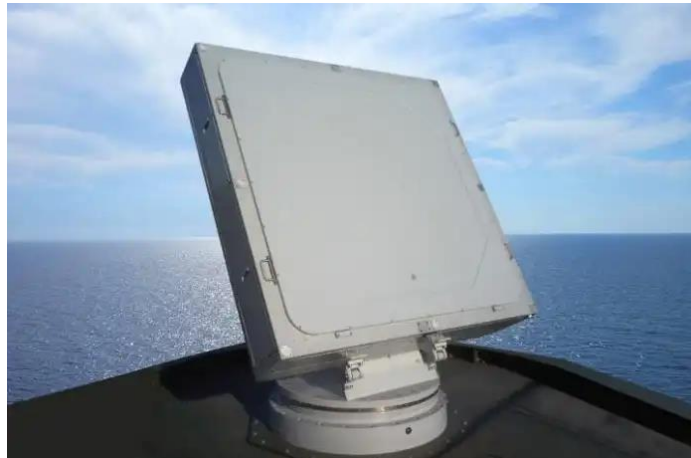
Figura 3: Antena de radar AESA. (Fuente: Zona militar, 2021)
