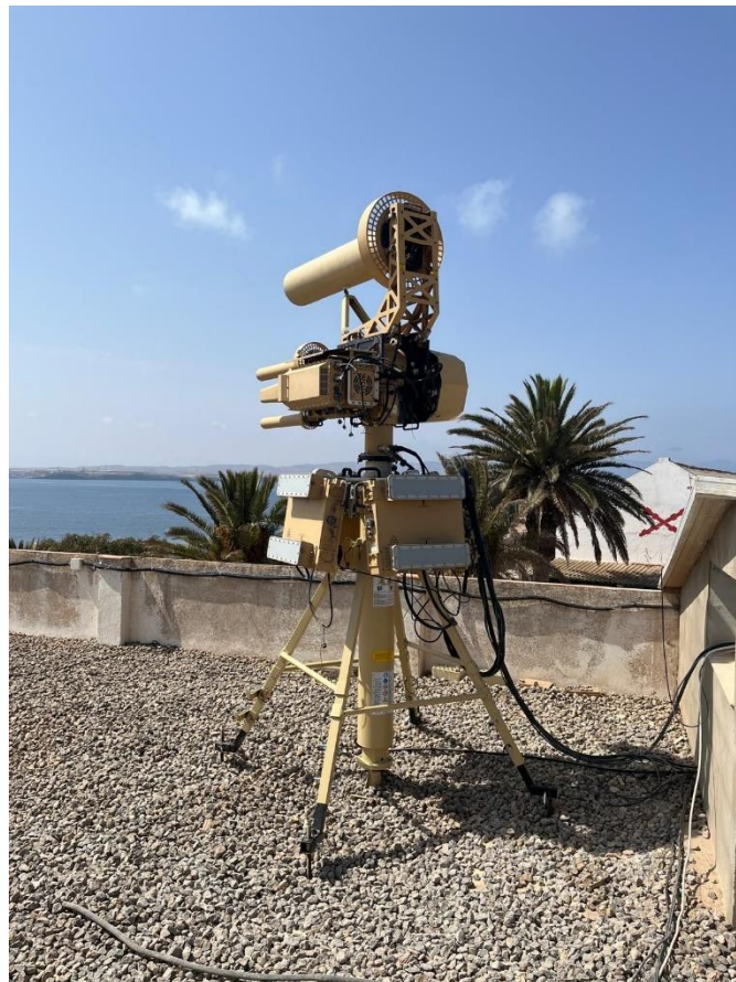
Figura 6: radar AUDS (Fuente: elaboración propia)
