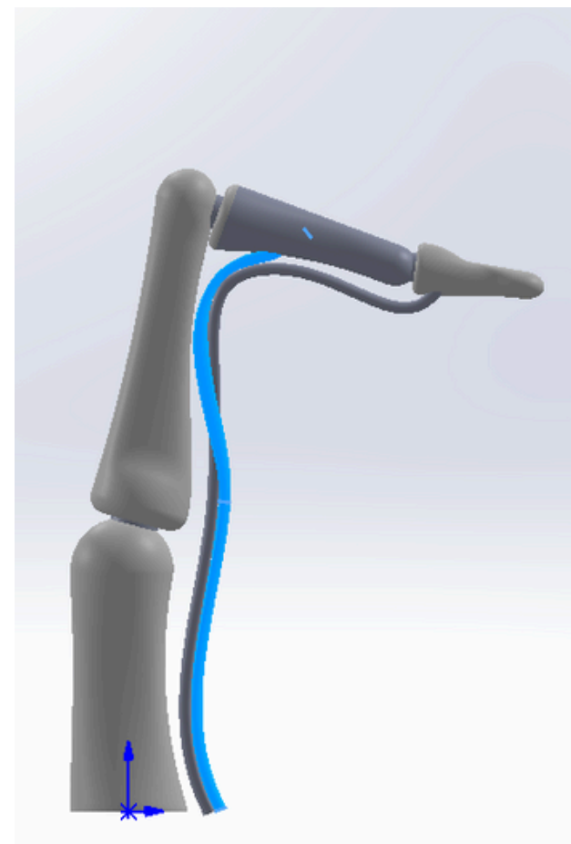
Figura 3.5.31: tendón superficial y profundo (falange proximal a 15°, media a 30° y distal a -10°)
