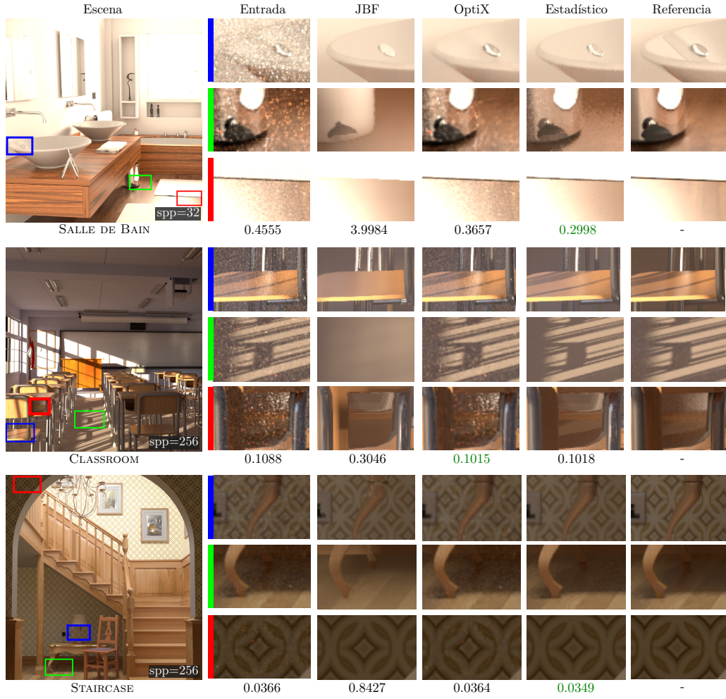
Figura 4.2: Resultados del denoising estacionario. Se muestran tres escenas (BATHROOM, CLASSROOM, STAIRCASE) renderizadas con 32, 256 y 256 muestras por píxel (spp) respectivamente. Para cada escena se presentan diversos insets con cinco columnas: imagen original ruidosa, resultado del Joint Bilateral Filter (JBF), resultado de OptiX (NVIDIA OptiX AI-Accelerated Denoiser), resultado del método propuesto, e imagen de referencia (30k spp). Se utiliza el RMSE para comparar cada método con la referencia. Se observa cómo el JBF reduce efectivamente la varianza pero tiende a difuminar detalles como reflejos y sombras. OptiX, aunque basado en redes neuronales, presenta ruido residual en regiones complejas. El método propuesto, mediante la combinación de JBF y membresías estadísticas, logra reducir la varianza preservando simultáneamente detalles finos como reflejos especulares y sombras, evitando la introducción de sesgo en regiones con fenómenos lumínicos complejos.
