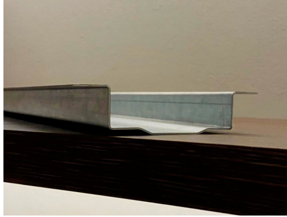
Figura 1.6: Pieza realizada mediante estampado. Imagen proporcionada por Transformados Técnicos Aragón S.L.
