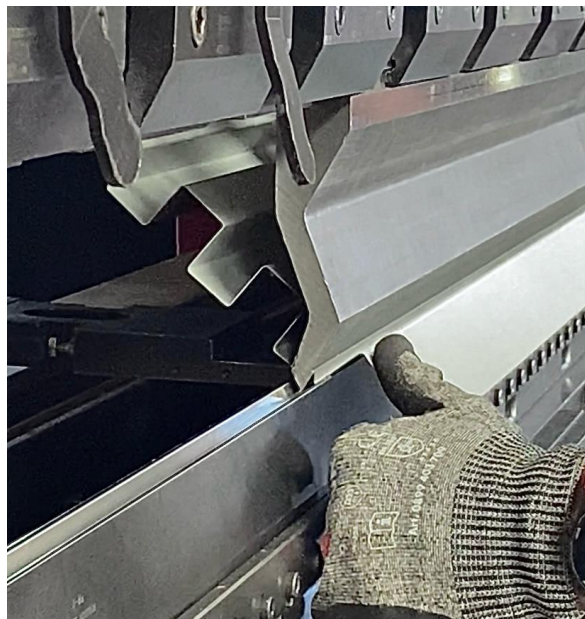
Figura 1.2: Proceso de plegado. Imagen proporcionada por Transformados Técnicos Aragón S.L.
