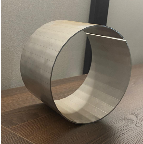
Figura 1.7: Pieza realizada mediante curvado. Imagen proporcionada por Transformados Técnicos Aragón S.L.
