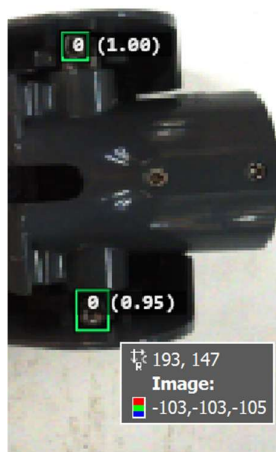
Ilustración 62. Detección de tornillo 2 con coordenadas en píxeles de una esquina
