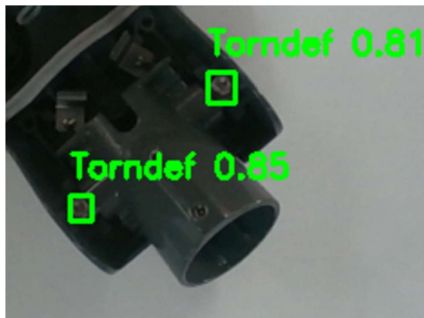
Ilustración 46. Detección de tornillos con YOLOv8 medium
