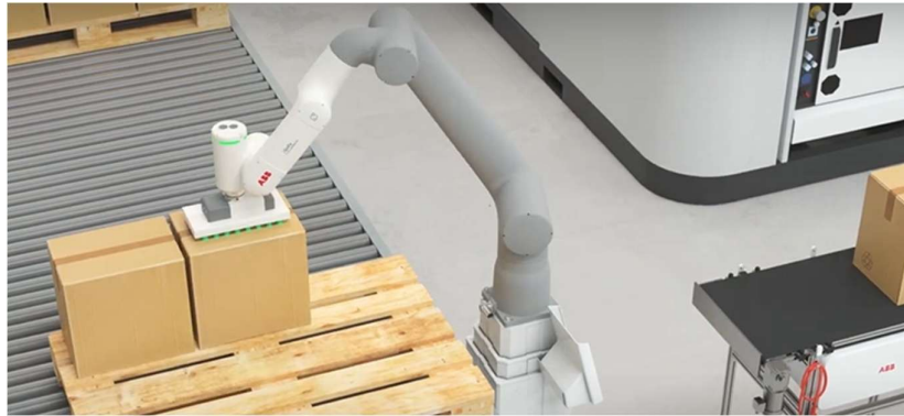
Ilustración 14. GoFa12 en una estación de despaletizado
