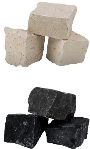
Fig. 2. Adoquines tradicionales empleados en la calçada portuguesa. Arriba, piedra caliza (blanca); abajo, basalto (negro).
