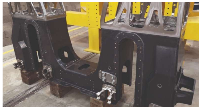
Figura 12. Prototipo en composites para ensayos a escala.
