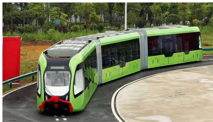
Figura 9. Tranvía autónomo ART (Autonomous Rail Rapid Transit), en China (CRRC, 2024).
