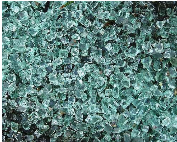
Figura 22. Fragmentos de vidrio templado tras su rotura.
