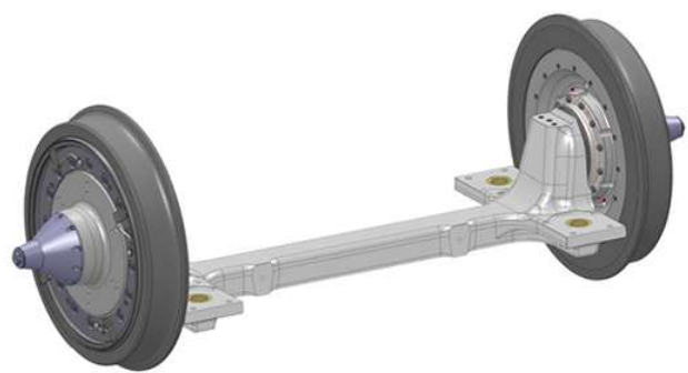
Figura 2. Eje montado de tranvía con eje para ruedas independientes.
