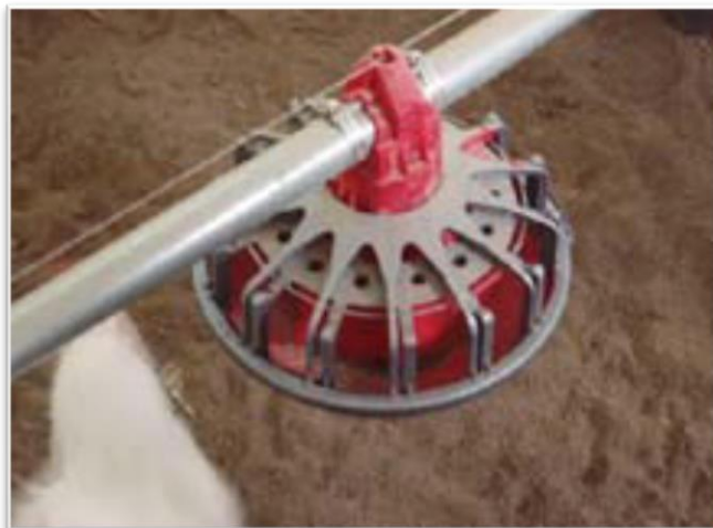
Ejemplo de comedero de plato definitivo de reparto automático.
