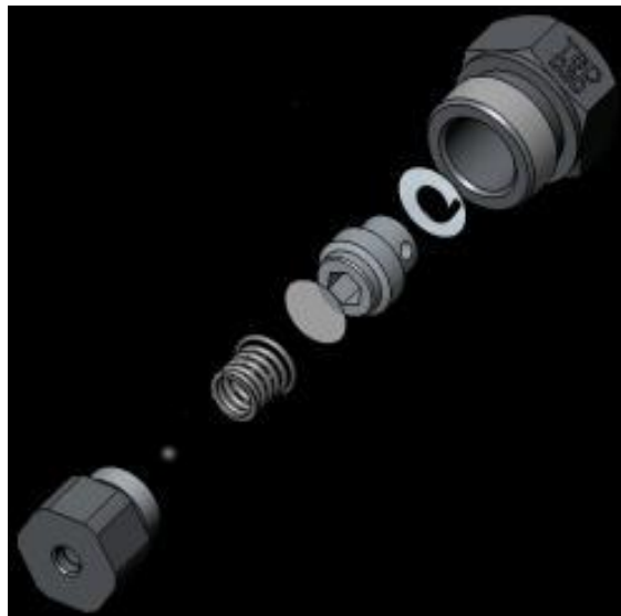
Detalle de despiece de boquilla de alta presión
