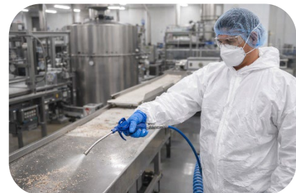
Figura 3.1. Limpieza en seco con la ayuda de pistola de aire a presión
