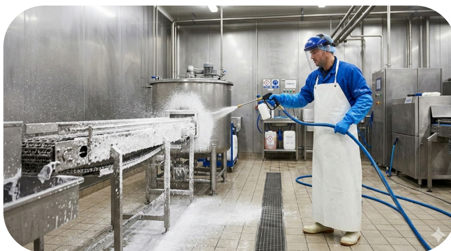
Figura 3.4. Limpieza en espuma en las superficies abiertas de la industria aliementaria
