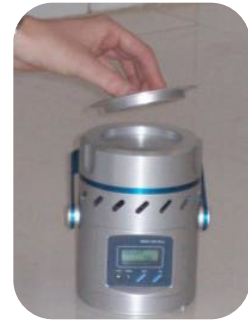
Figura 3.5. Aerobiocoleccionador para la toma de muestras de aire para su análisis microbiológico.
