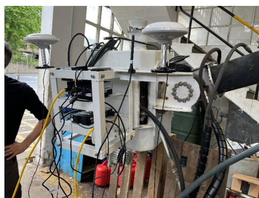
Figura 2: Detalle del cabezal de la grúa donde se observan los sensores GPS y láser
