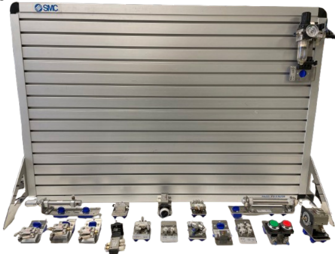
Figura 5. Componentes neumáticos disponibles y panel de montaje en el laboratorio
