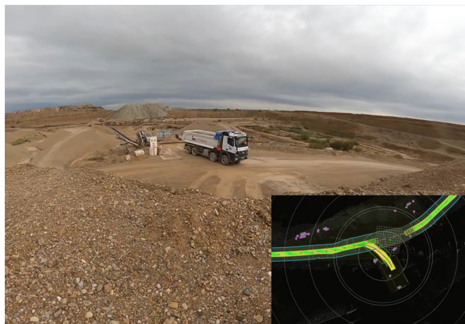
Figura 8: Maniobra de aparcamiento para la descarga en tolva.
