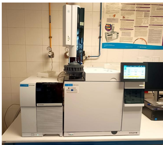
Figura 9: Cromatógrafo de gases empleado para el análisis
