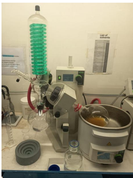
Figura 4: Destilación en rotavapor del metanol
