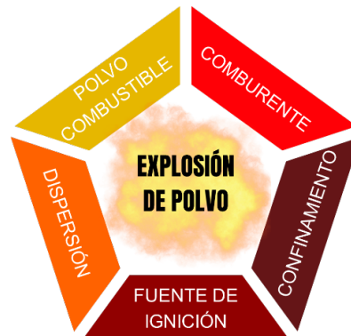
Figura 1. Pentágono de explosión de polvo
