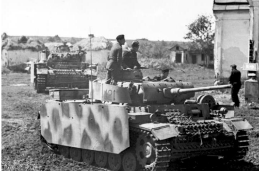
Figura 20: Blindaje espaciado Panzer III. Fuente: WikiTanks
