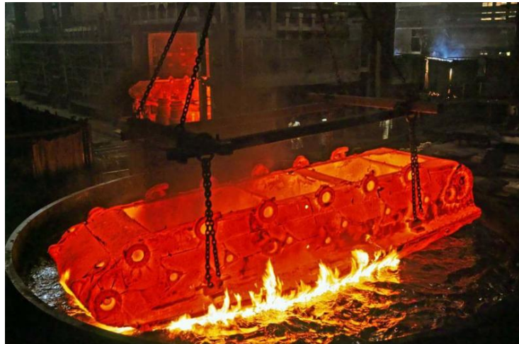
Figura 12: Chasis Panzer 68 de acero colado. Fuente: guerra-acorazada.blog
