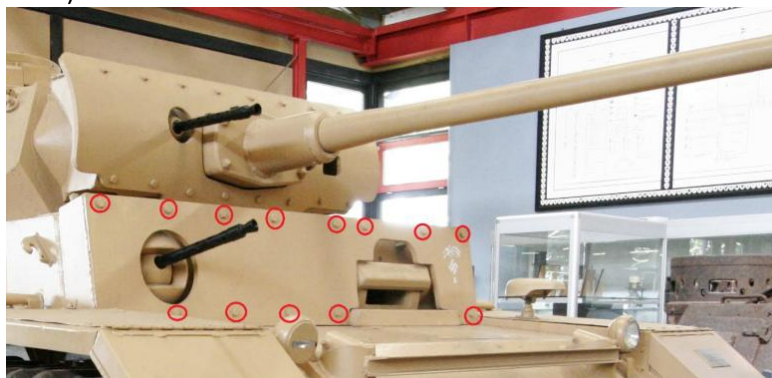
Figura 13. Placa 20mm acero cara endurecida Panzer III. Fuente: guerra-acorazada.blog
