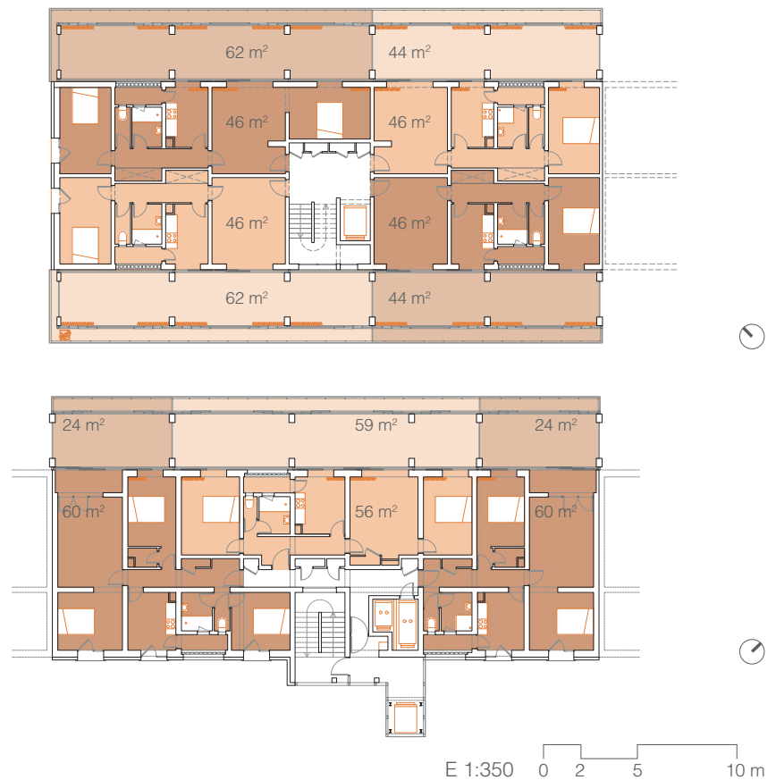
Figura 42. Planta superficies transformada del edificio G (superior) e I (inferior) de Grand Parc.
