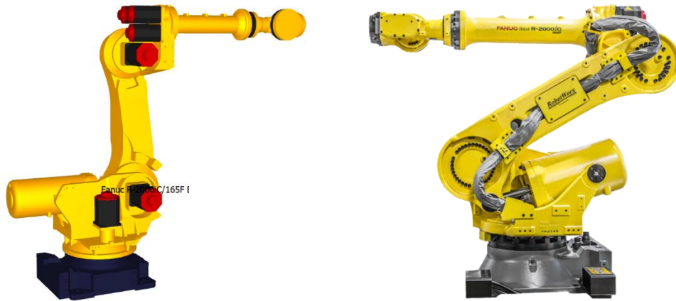
Ilustración 8: Robot Fanuc R-2000iC/165F, representación en el entorno de simulación frente a la unidad industrial real.
