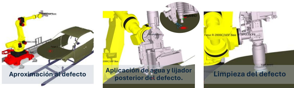
Ilustración 10: Esquema del proceso y acotación de las fases automatizadas en este estudio.
