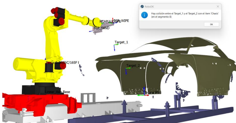
Ilustración 16: Resultado de la implementación programa en Python , que devuelve la existencia de colisión entre dos Targets, con el siguiente mensaje “ Hay colision entre el target_n y el target_n+1 en el segmento i.
