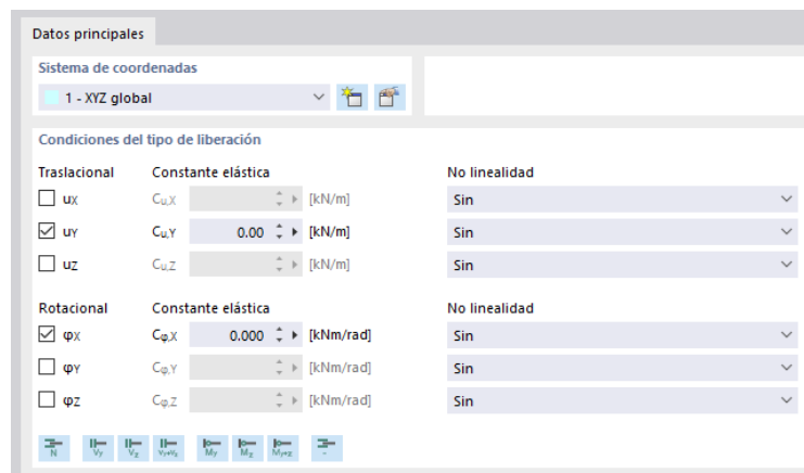
Figura 18: vinculación vigas longitudinales – pilares (3x3)
