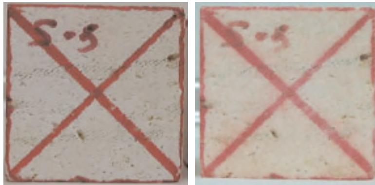
Figura VII-8: Aspecto de una de las probetas de la roca 17-CFS en los ciclo 0 (foto izquierda) y 30 (foto derecha) de cristalización de sales.
