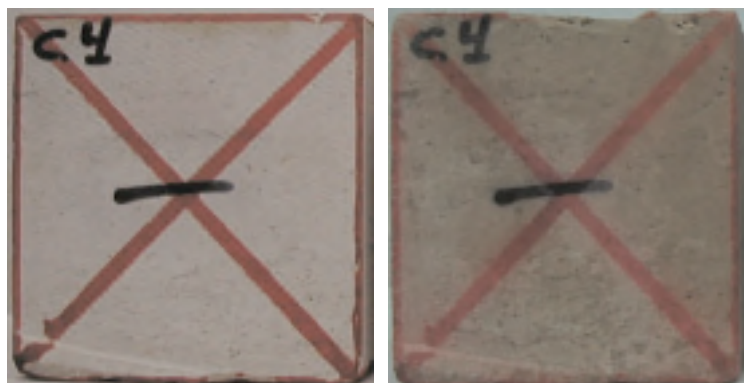
Figura VII-10: Aspecto de una de las probetas de la roca 9-Fr en los ciclo 0 (foto izquierda) y 30 (foto derecha) de cristalización de sales.
