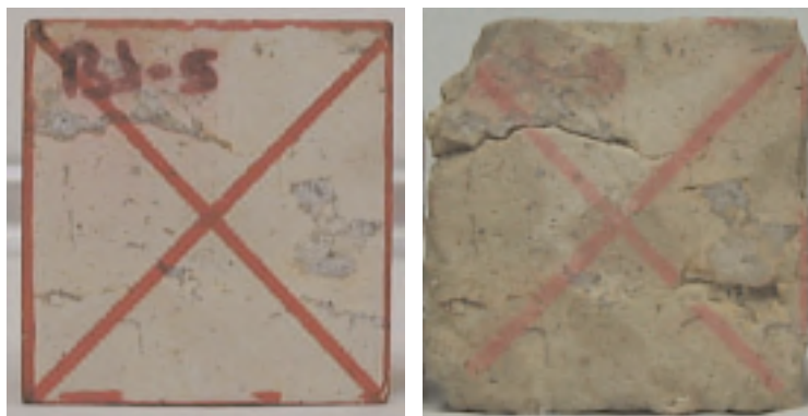
Figura VII-7: Aspecto de una de las probetas de la roca 31-B12 en los ciclo 0 (foto izquierda) y 30 (foto derecha) de cristalización de sales.
