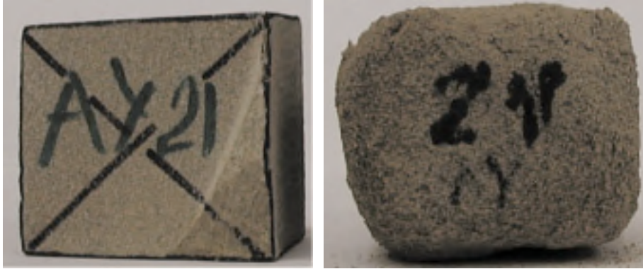
Figura VII-5: Aspecto de una de las probetas de la roca 7-Ay en los ciclo 0 (foto izquierda) y 15 (foto derecha) de cristalización de sales.
