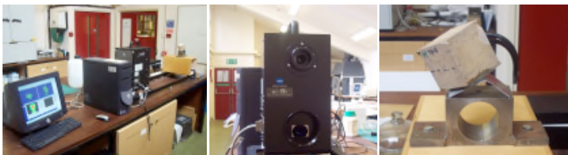
Figura III-4: Equipo utilizado para el ensayo de expansión volumétrica y portamuestras con la posición de la probeta durante la realización del ensayo.
