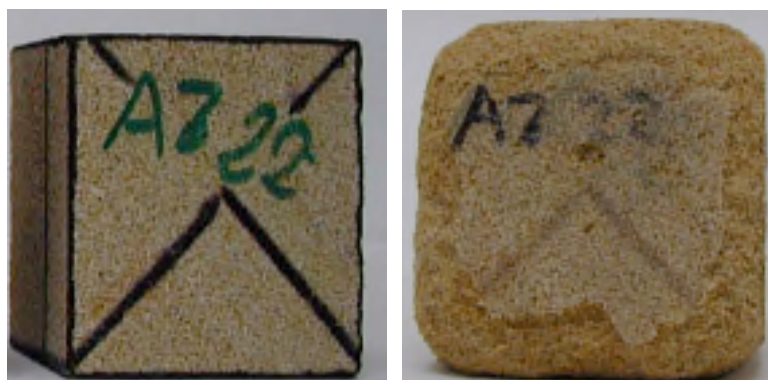
Figura VII-4: Aspecto de una de las probetas de la roca 10-Az en los ciclo 0 (foto izquierda) y 15 (foto derecha) de cristalización de sales.
