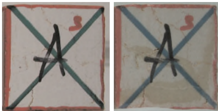
Figura VII-9: Aspecto de una de las probetas de la roca 29-A en los ciclo 0 (foto izquierda) y 30 (foto derecha) de cristalización de sales.
