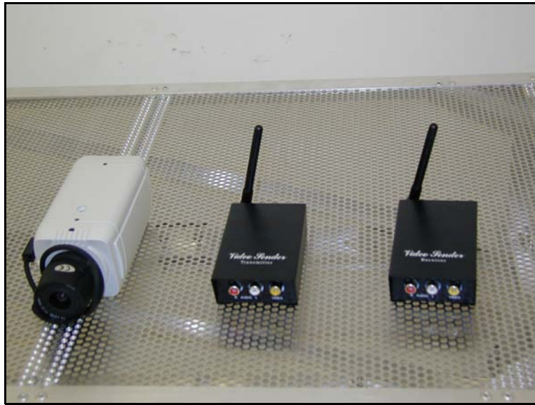
Imagen 3.15. Cámara del vehículo, emisor y receptor
