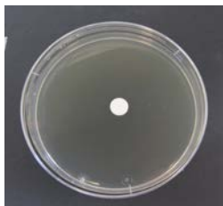
Fig. 2.7 Método de difusión (contacto directo): aplicación del disco activo en contacto directo con el medio de cultivo.
