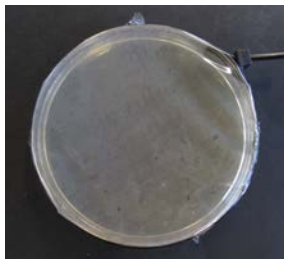
Fig. 3.3 Colocación del PET para su evaluación en fase vapor. Cierre mediante la brida de nylon.
