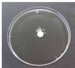
Fig. 2.8 Método de difusión (fase vapor): aplicación del disco activo en fase vapor, en la tapa de la placa Petri.
