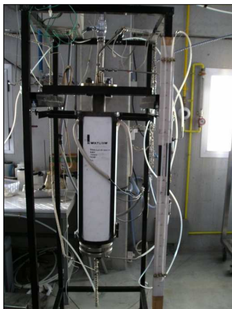
Figura 3.7. Esquema y fotografía de la instalación de lecho fluidizado discontinuo.
