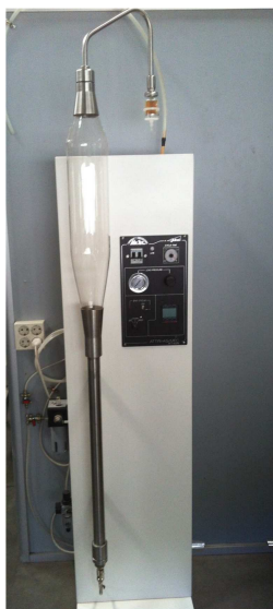
Figura 3.5. Equipo ATT-100M para medir la resistencia a la atrición de los transportadores de oxígeno.
