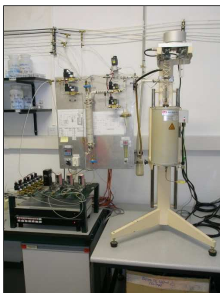
Figura 3.6. Esquema y fotografía de la instalación de TGA.
