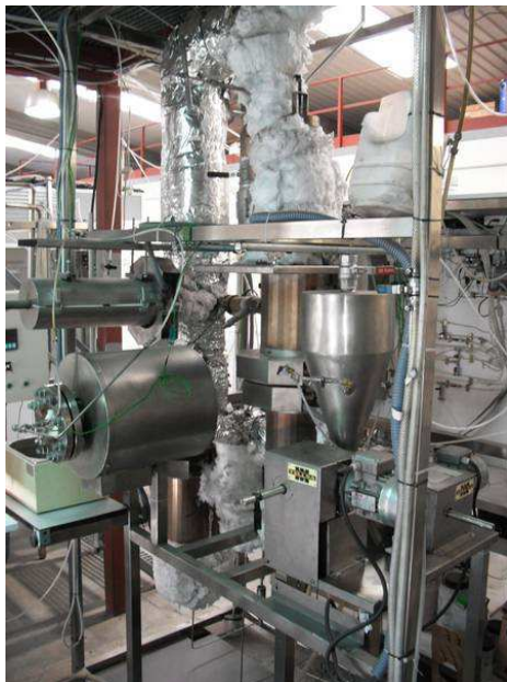
Figura 2.9. Unidad CLOU de 1.5 kW t en continuo para combustibles sólidos.
