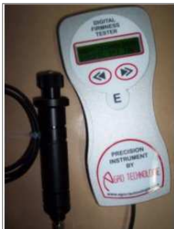
Figura 4.1 Durómetro digital AGROSTA 100Field
