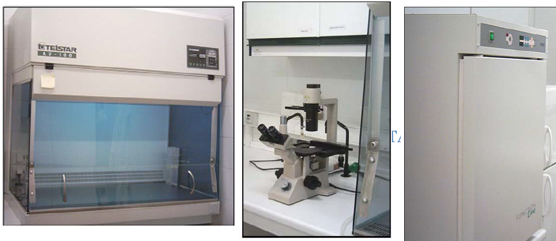
Figura 5.4: Imagen de la cabina de flujo laminar recirculante (imagen izqda), utilizada para la manipulación celular; del microscopio de luz invertida (imagen centro) utilizado para el examen visual y recuento de las células; y de la estufa de incubación (imagen dcha).
