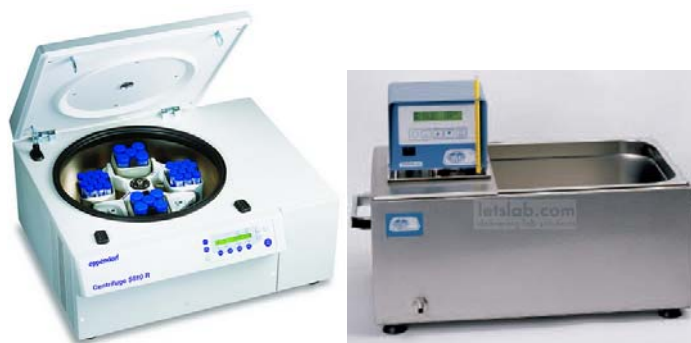
Figura 5.5: Centrífuga (imagen izquierda) para separar la muestra del medio y baño de agua (imagen derecha) utilizado para atemperar los medios.
