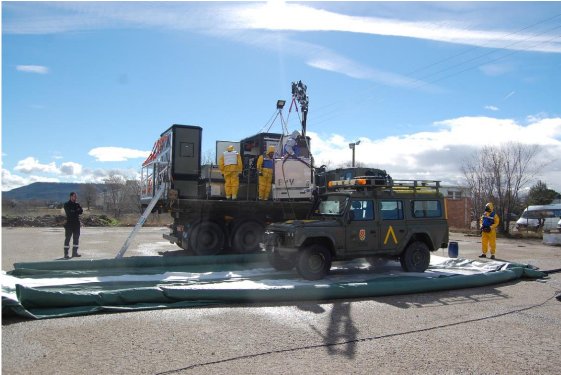
Figura 13. Estación de descontaminación de vehículos.
