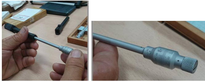
Figuras 2.4.4 y 2.4.5 En las figuras se muestra como se determina mediante un micrómetro de interiores el diámetro interno de un cañón (fuente ITM La Marañosa).
