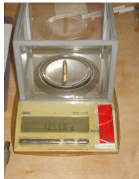
Figura 2.4.7 En la figura se muestra como se determina la masa de un cartucho de 9 mm PB (fuente ITM La Marañosa).
