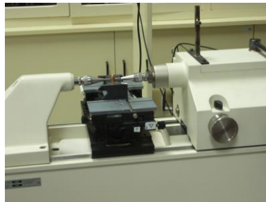
Figura 2.4.6 En la figura se muestra como se determina mediante una máquina de medición por coordenadas el diámetro externo de un proyectil de 9 mm Pb (fuente ITM La Marañosa).
