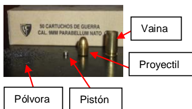
Figura 2.1.1.1 Componentes de un cartucho (fuente propia).
