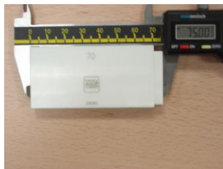
Figura 2.4.1.1 La figura muestra la lectura de un pie de rey sobre dos bloques patrón de 70 y 5 mm respectivamente (fuente propia).
