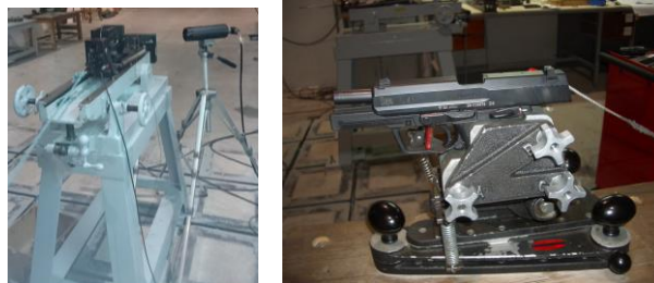
Figuras 2.5.3.1 y 2.5.3.2. De izquierda a derecha se muestra un banco de pruebas al que se le acopla un cañón probeta, y un Ransom Rest en el que se acopla una pistola HK USP para su empleo sin necesidad de ser empuñada por un tirador (fuente ITM La Marañosa).
