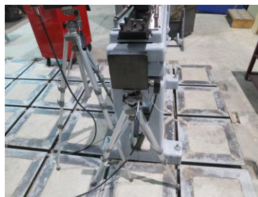
Figuras 2.4.12 La figura muestra un Radar Doppler Weibel situado en un banco de pruebas para realizar mediciones (fuente ITM La Marañosa).
