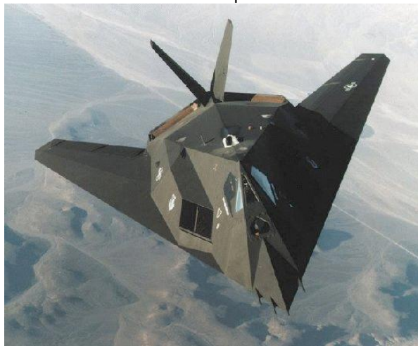
Fig.12.- F-117 con alas en delta, ejemplo de contramedidas de diseño
