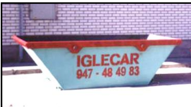
Imagen 20. Contenedor estándar de 6 metros de longitud. Capacidad de 8 Tm.
