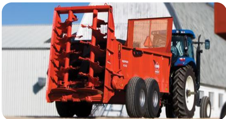
Esparcidor de estiércol de 17 m 3 y tractor de 150 CV equipado con pala.
