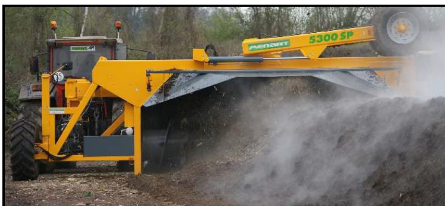
Imagen 10. Volteadora de pilas Menart 4800SP.
