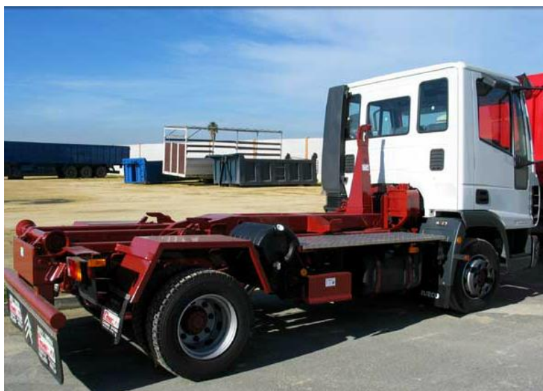
Imagen 16. Camión de pequeñas dimensiones para el transporte de contenedores.
