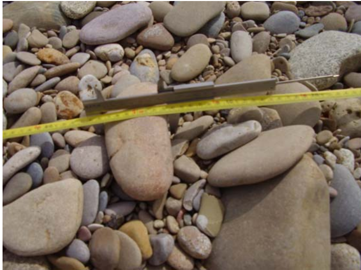
Figura 2. Medición del lado menor de un canto.
