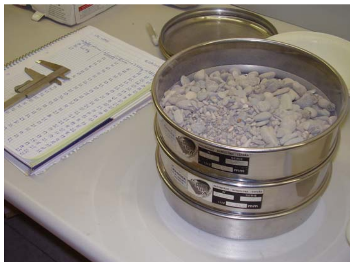
Figura 7. Tamizado de la muestra.
