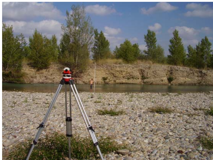
Figura 5. Toma de puntos para la sección del cauce.
