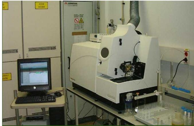
*Figura 7. Espectrómetro de masas*
