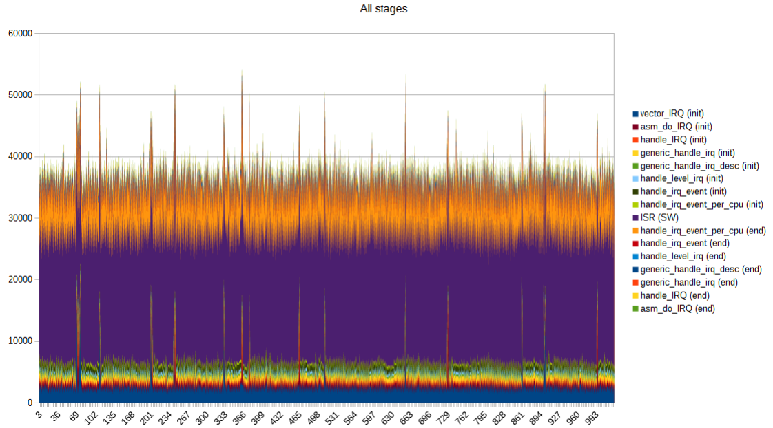
Figura 7: Medidas con picos de latencia (BeagleBone, expulsión total, no predicción de saltos)
