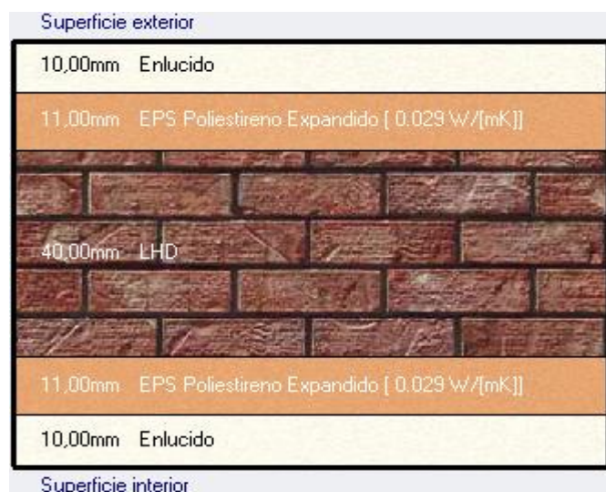
Figura 10: Sección de la tabiquería rehabilitada propuesta
