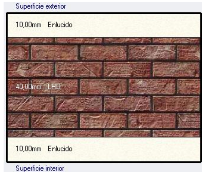
Figura 7: Sección de la tabiquería actual
