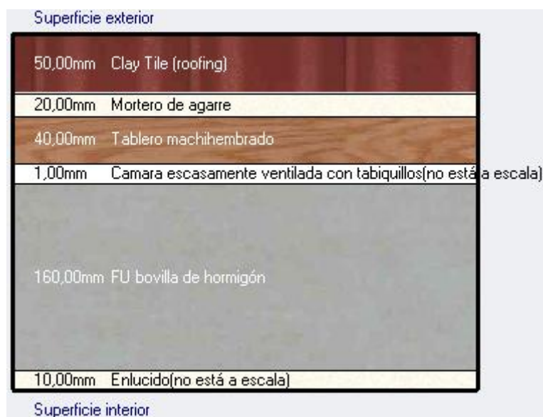
Figura 8: Sección de la cubierta inclinada actual
