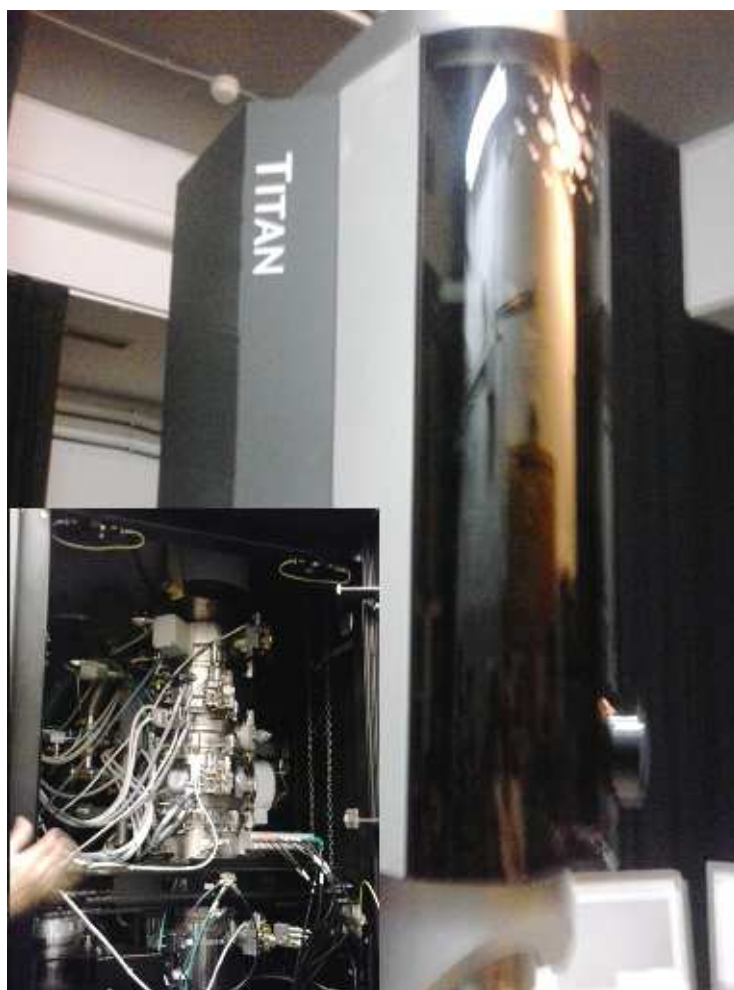
Figura 4.2: Microscopio TITAN STEM instalado en el LMA. Permite la exploración tomográfica de muestras con \pm 70^\circ de inclinación del eje.
