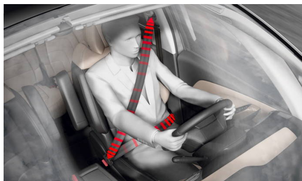
Figura 38 - Presión ejercida por los pretensores
