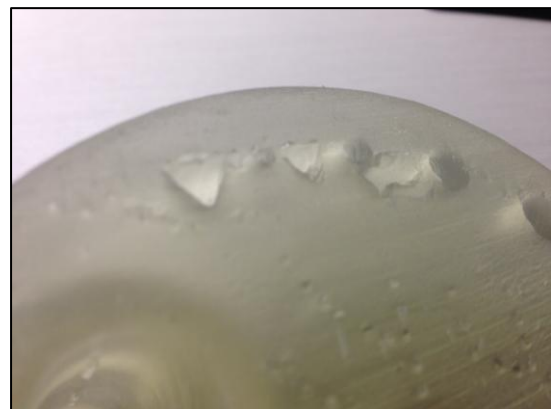
Figura 3.34 Error de construcción
