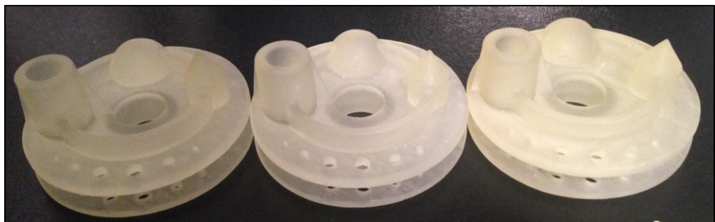
Figura 3.17 Pieza 1 en los 3 espesores de capa posibles
