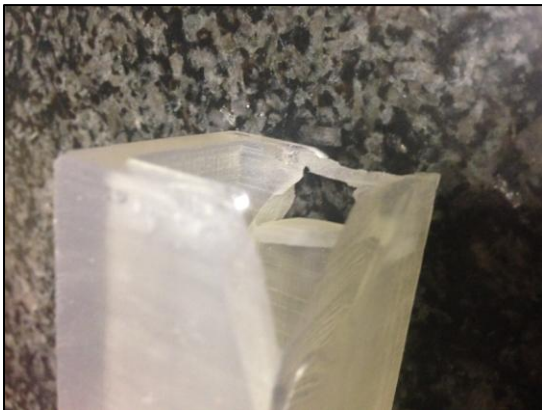
Figura 3.31 Error de adhesión
