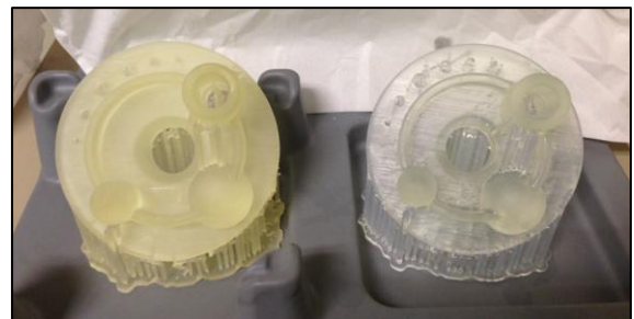
Figura 3.22 Pieza 1 después y antes de ser curada
