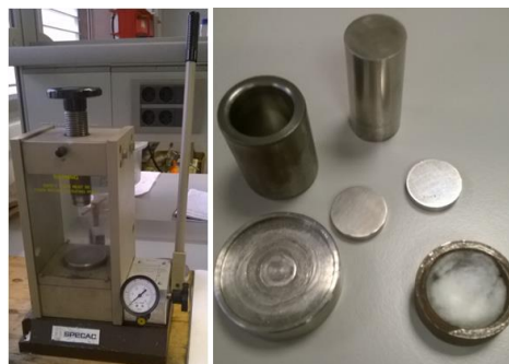
Figura7. Prensa manual en laboratorio de Departamento de Materiales y molde utilizados para conseguir monolito de superconductor.
