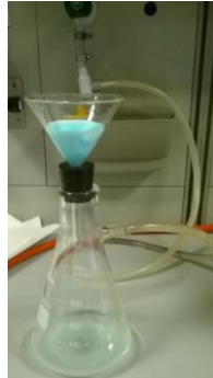
Figura4. Filtrado de precipitado en el que empleamos kitasato, embudo, filtro y se realiza vacío, obsérvese acople con trompa de agua.
