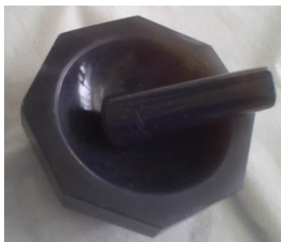
Figura5. Mortero de ágata con el que se consiguen polvos para su posterior análisis y procesado.
