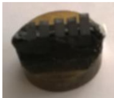
Figura19. Encapsula en latón de las fracturas de las distintas muestras.
