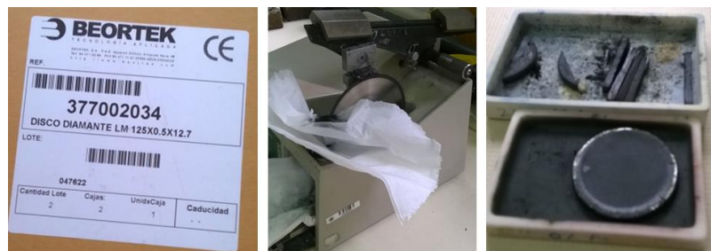
Figura11. Disco de diamante, disco montado sobre máquina cortadora y barquillas con monolito prensado uniaxial en caliente y con barras cortadas con disco de diamante.
