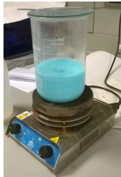
Figura3. Coprecipitación de disolución tras haber adicionado Ácido Oxálico y con el pH en torno a 4,5.
