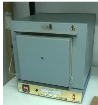
Figura6. Horno con los que se trabaja para el quemado y los tratamientos térmicos a 750°C y 800°C.
