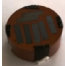
Figura 20. Empastillado en resina de cobre de distintas muestras con las que se ha trabajado.
