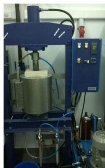
Figura9. Sistema de prensado en caliente utilizada en el proceso de texturado.
