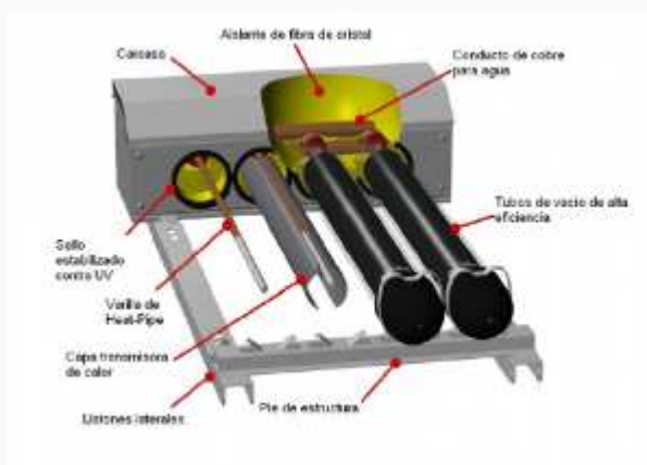
Figura 4. Composición de un colector de tubo de vacío.
