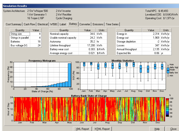
Figura 45. Estado de las baterías caso 3. Sistema más estable con menor cantidad de profundas descargas de las baterías.
