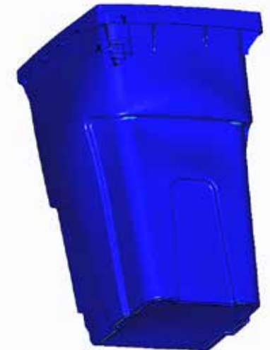
Figura 6.2.2.4 Deformaciones cubo 3,7 mm
