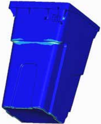
Figura 6.2.1.1 Tensiones cubo 3,7 mm
