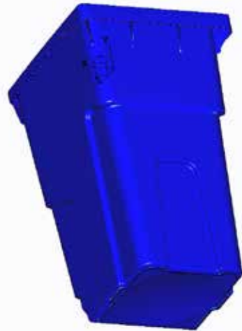
Figura 6.2.1.3 Deformaciones cubo 3,7 mm
