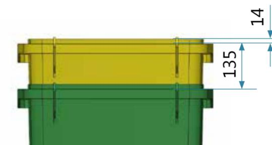
Figura 3.3.13 Separación de apilado
