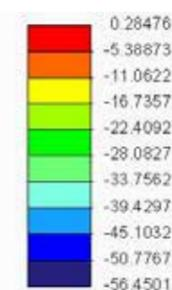
La zona coloreada de naranja se ha desplazado 6 mm hacia abajo debido al giro del cubo, mientras que la zona coloreada de morado se desplaza 56 mm. Por lo tanto se tiene una flecha en el fondo del cubo de 50 mm en el eje Y.
