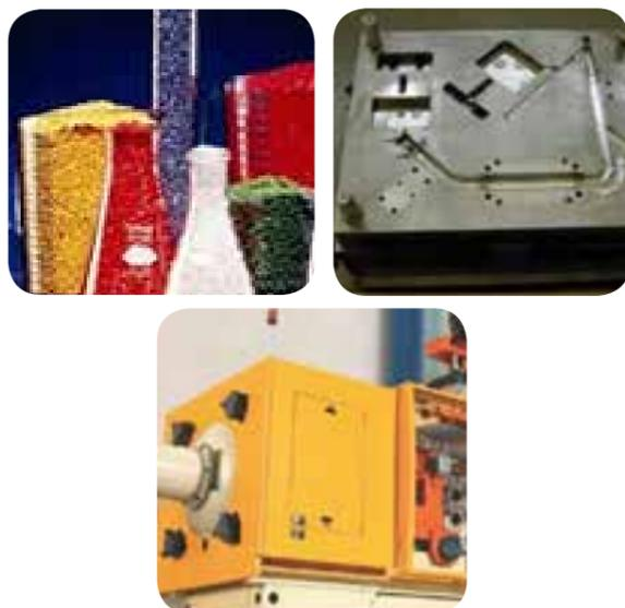
Figura 1.4.1 Granza de plástico, molde de inyección y máquina de inyección [12]
