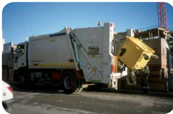
Figura 1.1.1 Camión-contenedor carga trasera [2]
