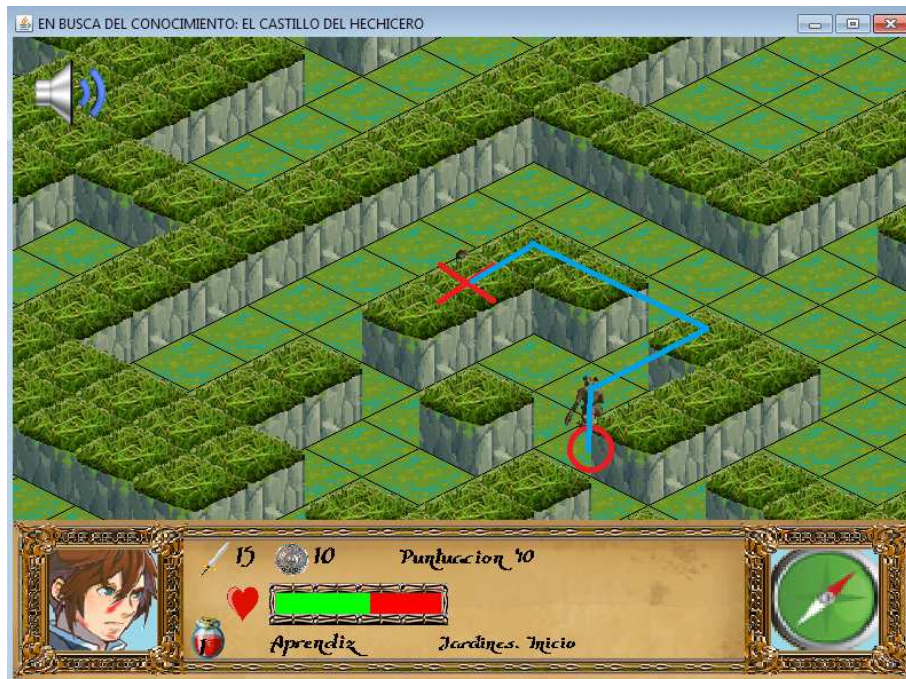
Figura 9. Recorrido del enemigo en busca del jugador, a través del cálculo de camino óptimo con el algoritmo A*.
