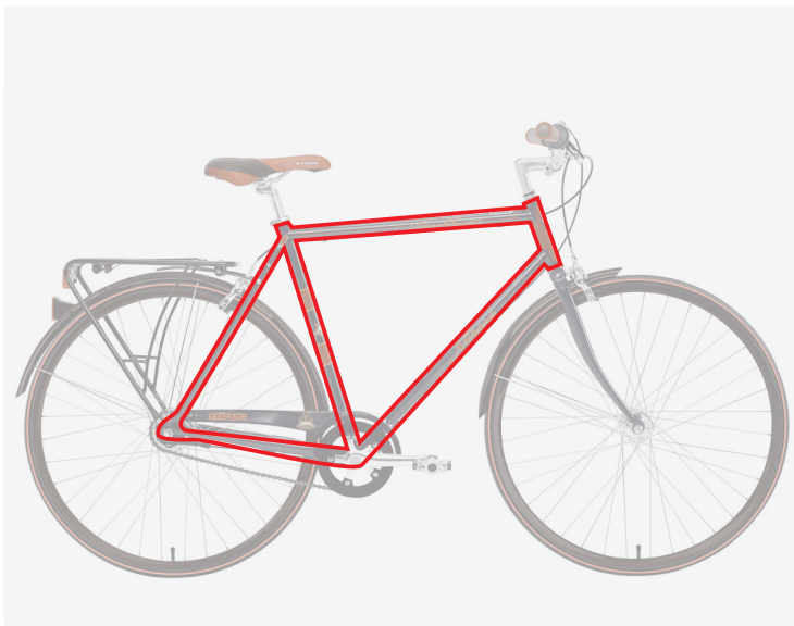
Figura 11. Estructura tradicional de doble triángulo.
