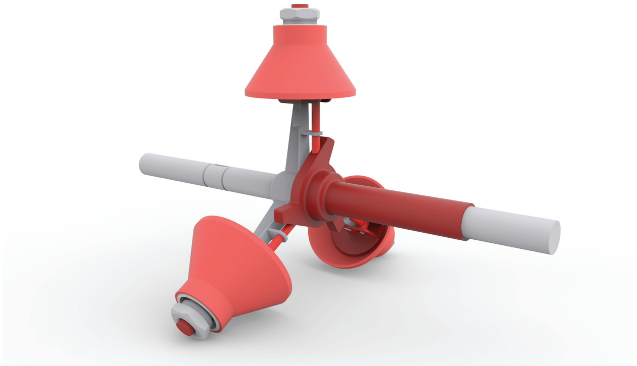
Figura 10. Discos y su sistema de accionamiento.
