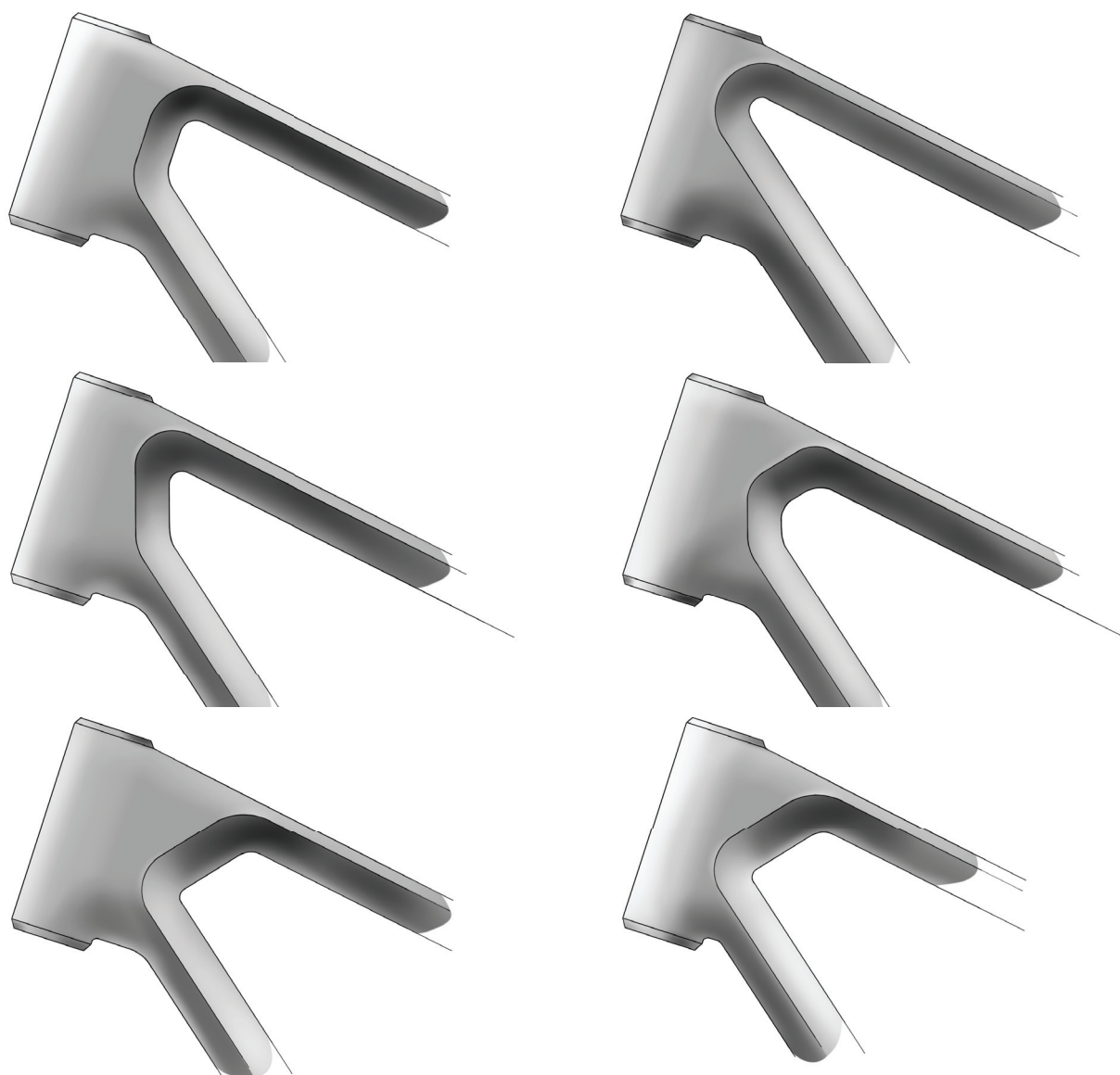
Figura 59. Variaciones del tubo de dirección.
