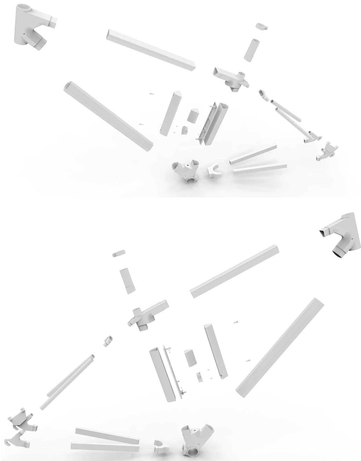
Figura 80. Vista explosionada de las diferentes partes de que consta la bicicleta.
