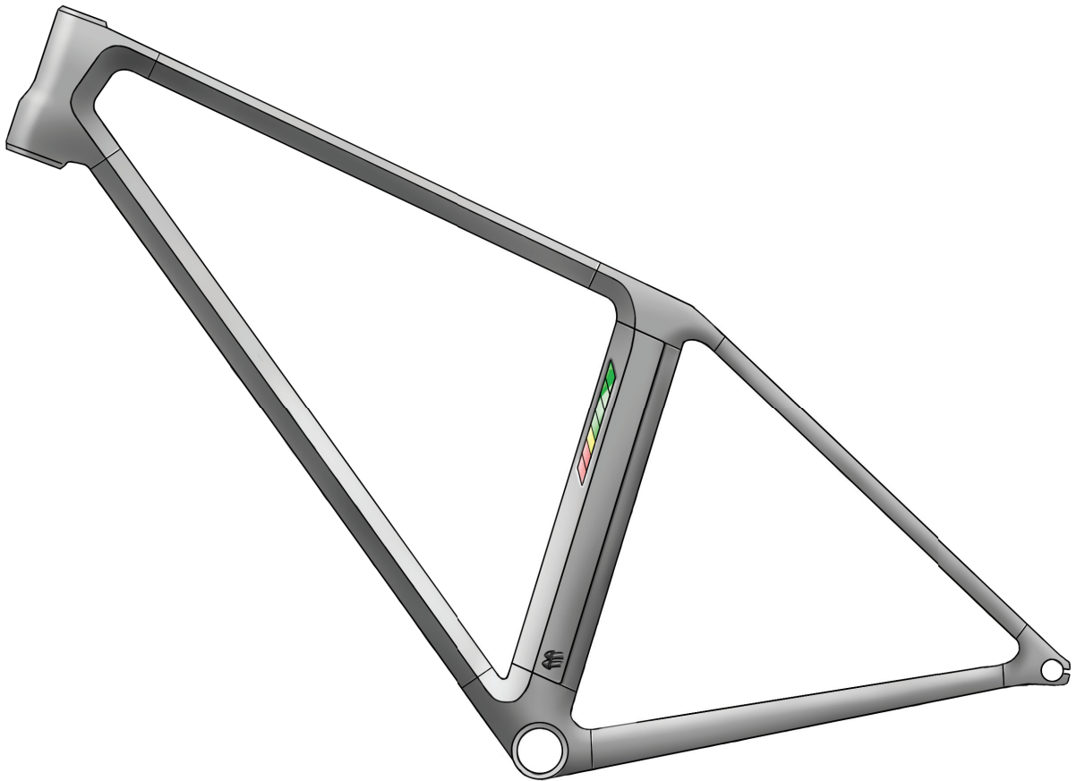
Figura 64. Se aprecia el resultado con el tubo del sillín siendo ahora el que aloja los componentes.
