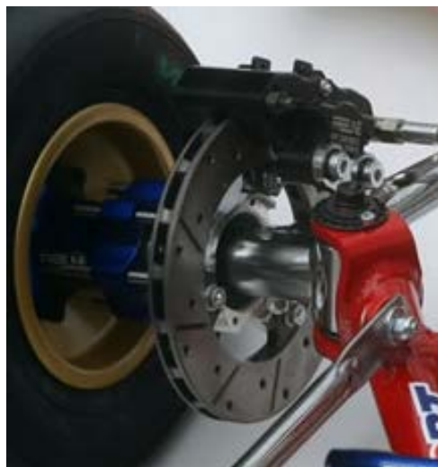
Figura 6.21. –Freno completo delantero.
