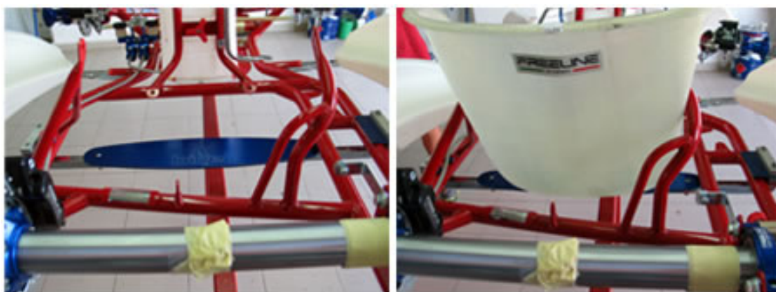
Figura 4.14.-Montaje del asiento.
