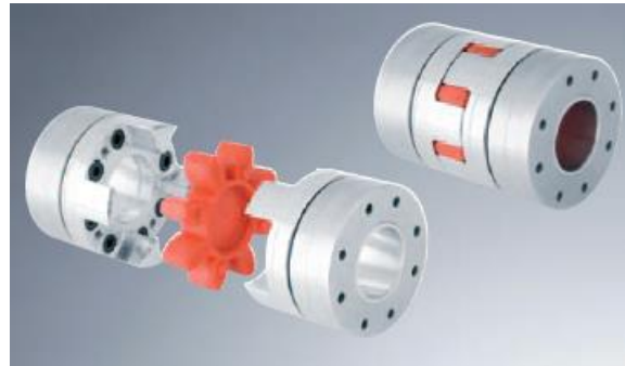
Abbildung 3.5: Elastomerkupplung ROTEX GS [KTRK14, S.156]
