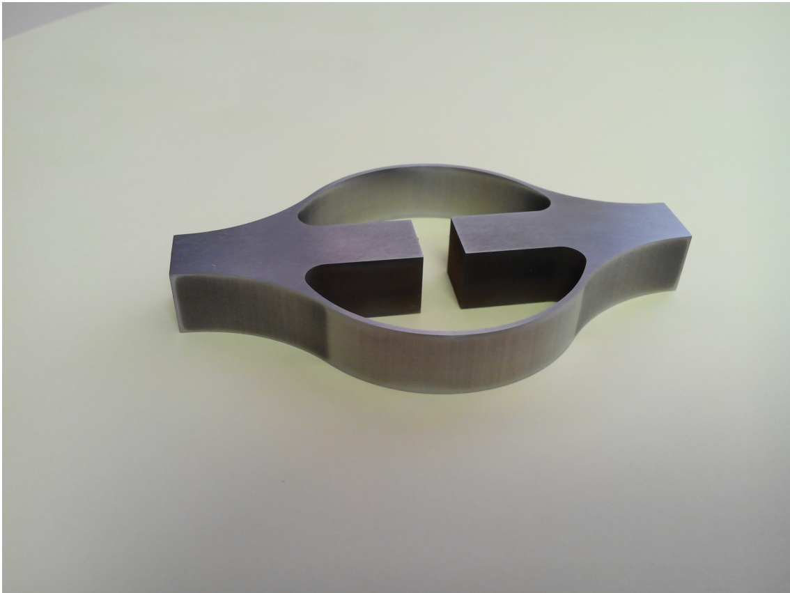
Figura 18. Célula de carga tras EDM.
